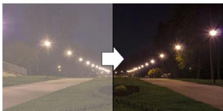
Wenn die Sicht durch Nebel oder Rauch beeinträchtigt wird, passt diese Funktion die Werte für Farbe, Kontrast und Kantenschärfe an, um ein klareres Bild zu erhalten.
